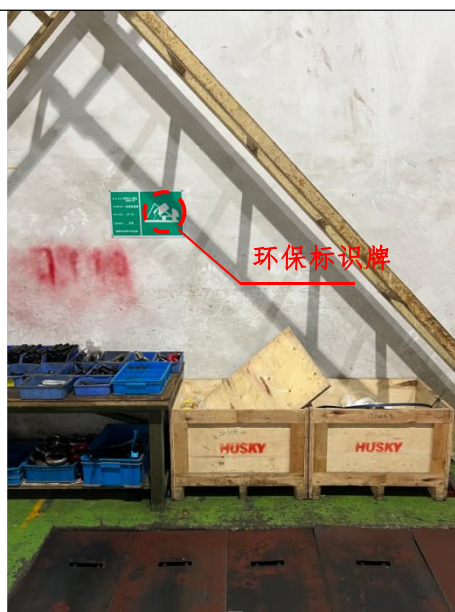
一般固废堆场位于室内，已落实防风防雨等措施，环保标识牌已落实。
